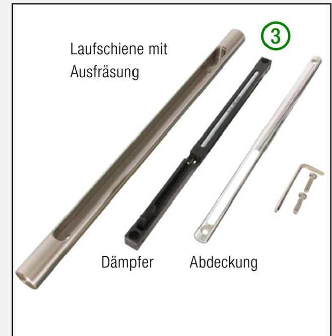
1 Sollte durch unsachgemäßen Gebrauch einmal der Austausch des Dämpfer-Moduls nötig sein, muss nicht die ganze Tür samt Laufschiene demontiert werden. Nach dem Lösen zweier Schrauben kann der Deckel von der Laufschienausfräsung entfernt und das Dämpfermodul entnommen werden.
